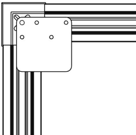
Drehen Sie die vier Halteplatten **G** leicht auf die Befestigungsschrauben **H** auf. Achten Sie hierbei darauf, dass etwas Abstand zwischen den Halteplatten und dem Rand des Gitterrosts vorhanden ist.
