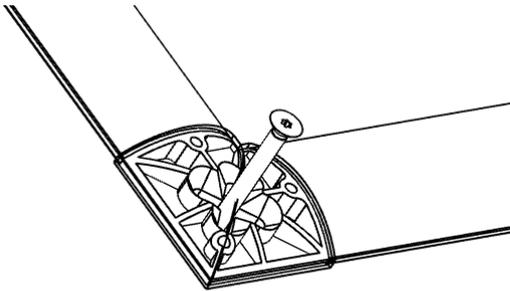
Stecken Sie die vier beiliegenden Schrauben **H** in die Öffnungen der Eckverbinder **F** ein, so dass diese auf der Rückseite des Aluminiumrahmens herausstehen.
